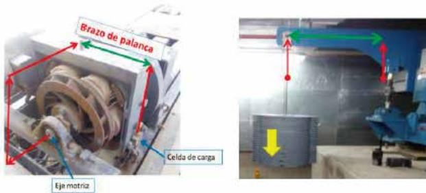
Imagen 3. Brazo de palanca en dinamómetros
