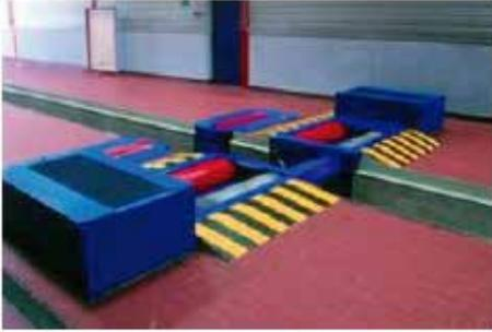
Imagen 1. Dinamómetros utilizados en CVV.
