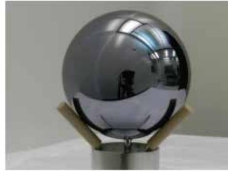
**Fig. 5. Patrón de masa fabricado en silicio natural del PTB y prestada a CENAM para su estudio de estabilidad de masa.**
