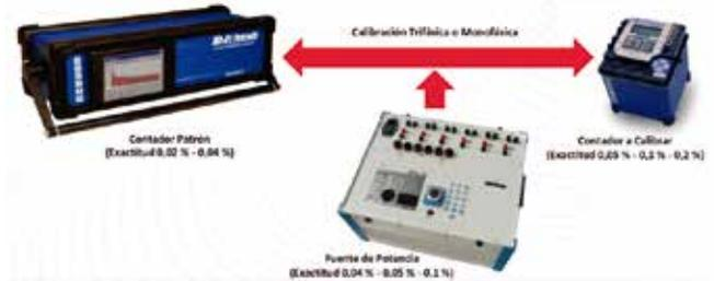
Se llamará patrón al contador patrón que actúa como referencia y contador al contador patrón que se desea calibrar. En la Tabla 2 se indica la exactitud del patrón seleccionado según el contador a calibrar:
